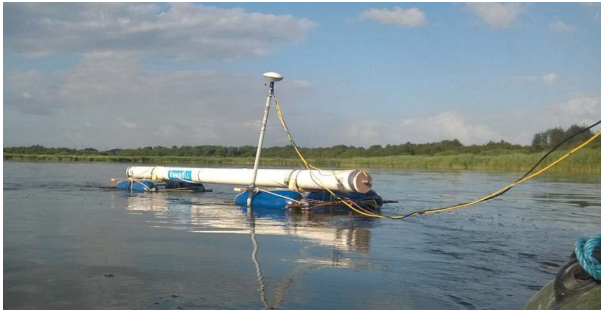
Figur 10. Instrument set up, placeret på fændere, der trækkes efter en motordrevet gummibåd.
