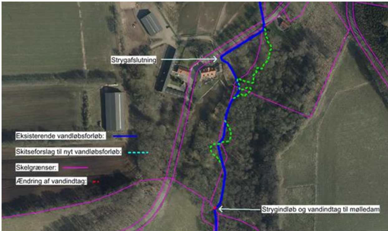
Skitse 1 med strygafslutning opstrøms vejunderføring
