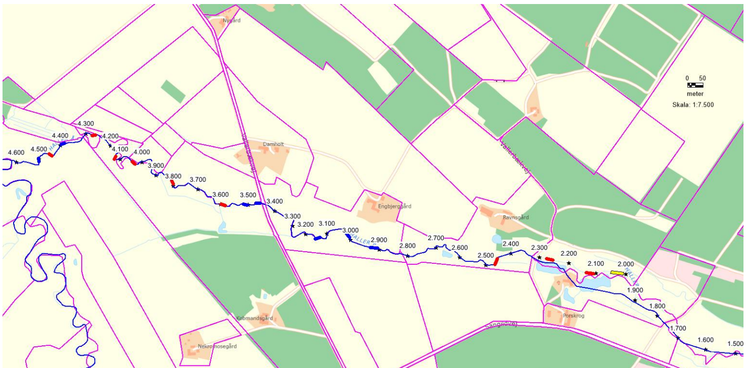
Skitse 2 hvor forslag til udlægning af gydegrus og skjulesten er vist med rødt. Placering af sandfang er vist med gult. Eksisterende gydebanker er vist med blå. Skitsen omfatter den offentlige strækning fra st. 2.000 – 4.600 (udløbet i Karup Å)
